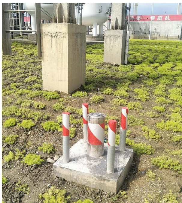
图 4.2-2 地下水监测井
